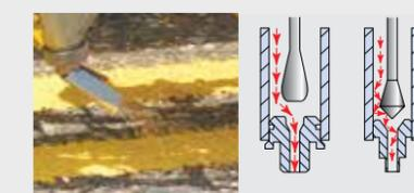
Graco ofrece un diseño de aguja en forma de lágrima para que las microesferas fluyan suavemente alrededor de la superficie de la aguja, lo que limitará la turbulencia (vibración de las microesferas) dentro de la pistola para prolongar la vida útil.
